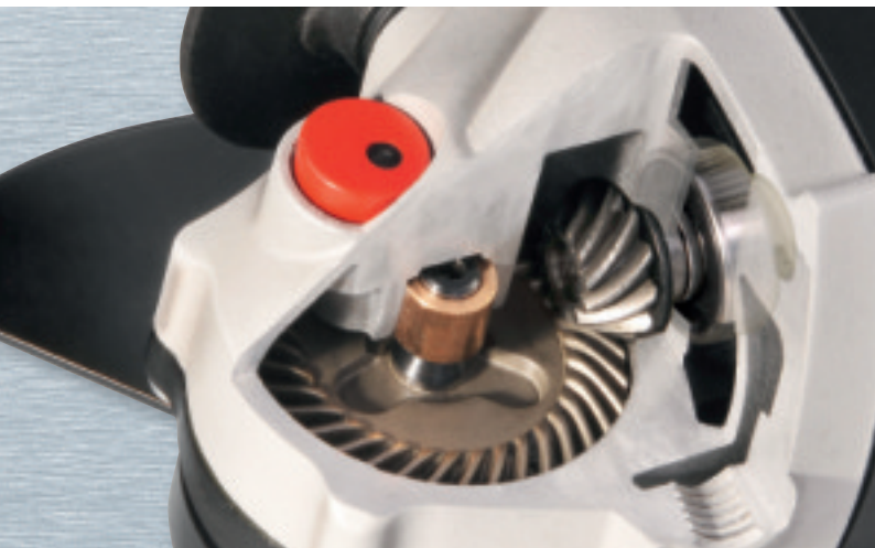
Spiralni zupčanik, kuglični ležajevi zaštićeni od prašine u brusilici.
