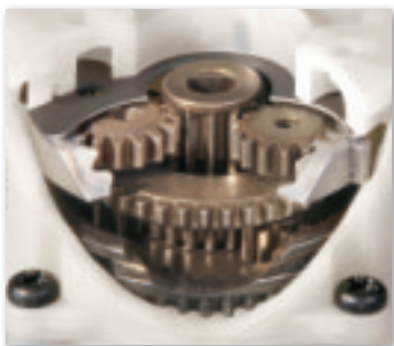
Rotirajući zupčanici u akumulatorskoj bušilici/odvrtaču.
